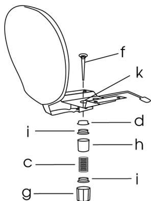
5. Раскрутите спрингсет на болт (f), пружину (c), три шайбы (d) и (i), кожух-гайку (h) и кожух пружины (g).
