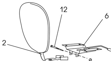
4. Соедините кронштейн спинки кресла (2) с механизмом качения (6), продев шплинт (12) через два отверстия механизма качения, как показано на рисунке.
