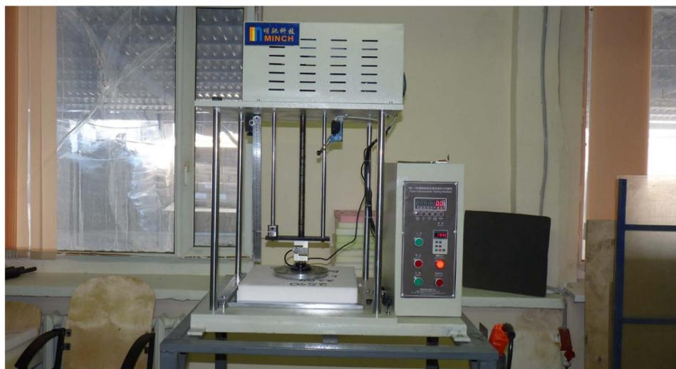
Здесь твердость поролона определяется согласно требованиям ГОСТ 26605-93. Образец поролона продавливается специальной круглой пластиной диаметром 200 мм – индентором – на 70% толщины образца 3 раза подряд. После чего индентор осуществляет вдавливание еще раз, и с помощью высокоточного датчика пр-ва США снимаются показания сопротивления давлению:
