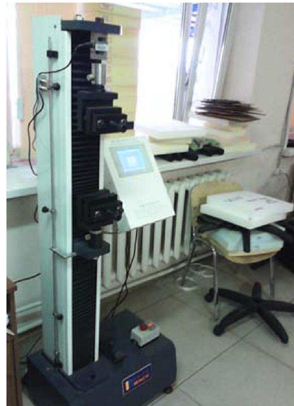
Он предназначен для тестирования обивочных материалов на разрыв согласно требованиям ГОСТ 3813-72.
