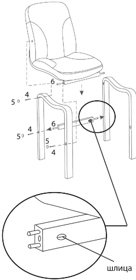
**Внимание!** Проверьте внутреннюю сторону царги (10 а,б). Шлица на гайке должна быть строго паралельно оси царги. При необходимости выровните отверткой (вставьте отвертку в шлицу и поверните влево, вправо). Отвертка в комплект фурнитуры не входит.
