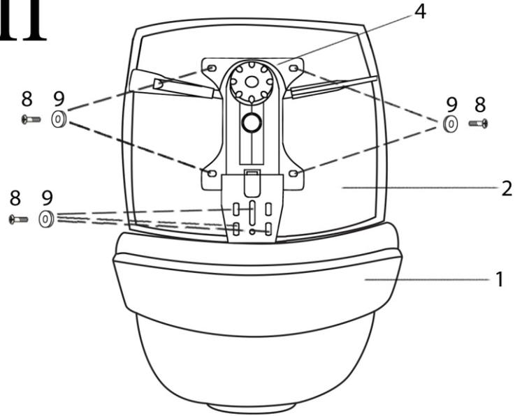
3. Прикрутите механизм качания (4) к нижней части сидения (2), используя 4 винта (8) и шайбы (9).
