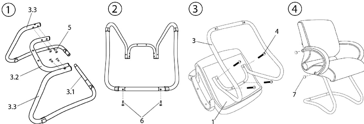
1. Соедините боковины каркаса (3.3) через нижнюю перемычку (3.1), как показано на схеме 1. Соедините верхнюю перемычку (3.2) с боковинами каркаса и зафиксируйте её винтами (5) при помощи шестигранного ключа.
