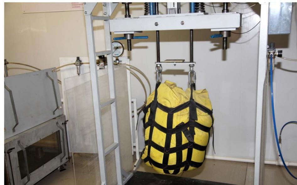
Мы очень любим демонстрировать этот стенд новым сотрудникам, впервые приходящим на экскурсию в нашу испытательную лабораторию: испытания на нем очень зрелищны. Здесь проводится целых четыре вида испытаний – для сиденья кресла в самом высоком и самом низком положениях, при двух типах нагрузки для каждого из положений – функциональной (102 кг) и максимальной (136 кг).
